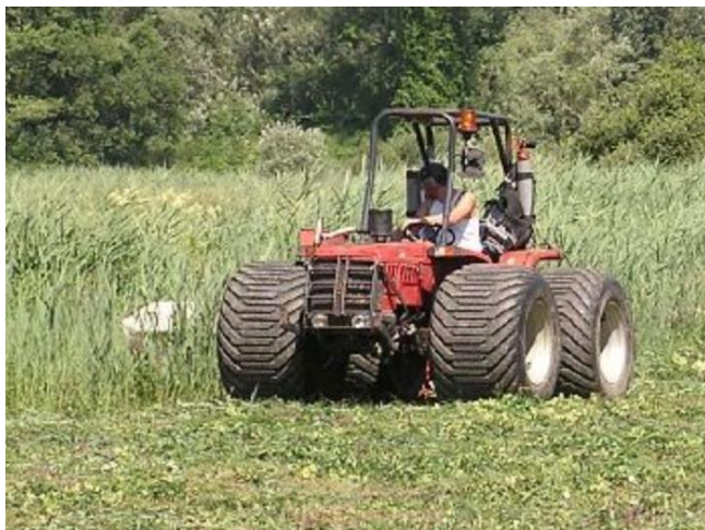
Pneus basse pression (fort volume d'air, forte capacité de déformation)
